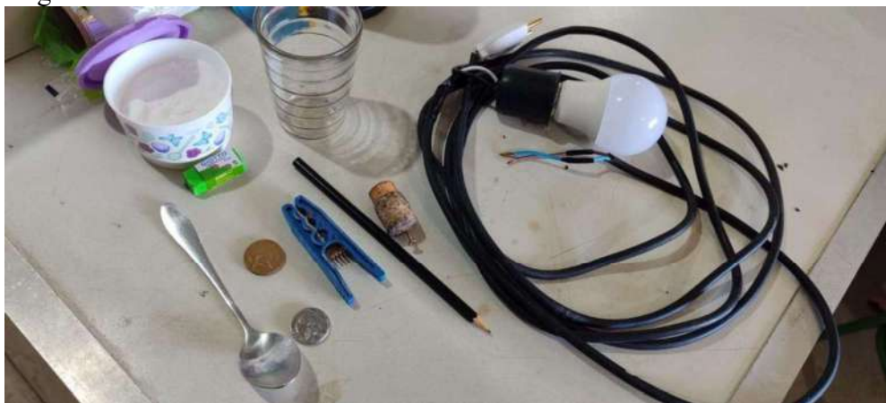
Figura 12 - Circuito e materiais utilizados no teste de condutividade elétrica
