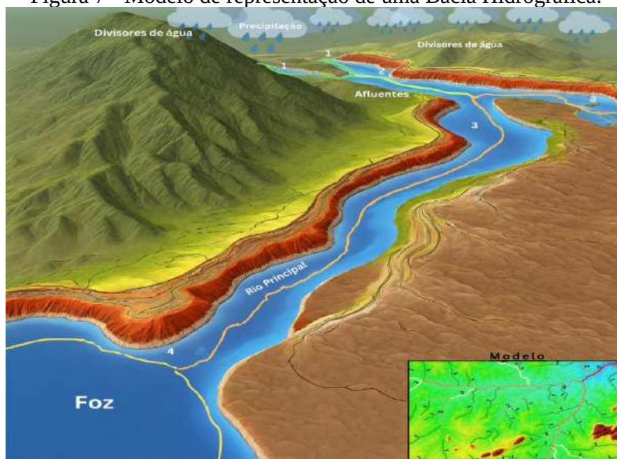
Figura 7 - Modelo de representação de uma Bacia Hidrográfica.
