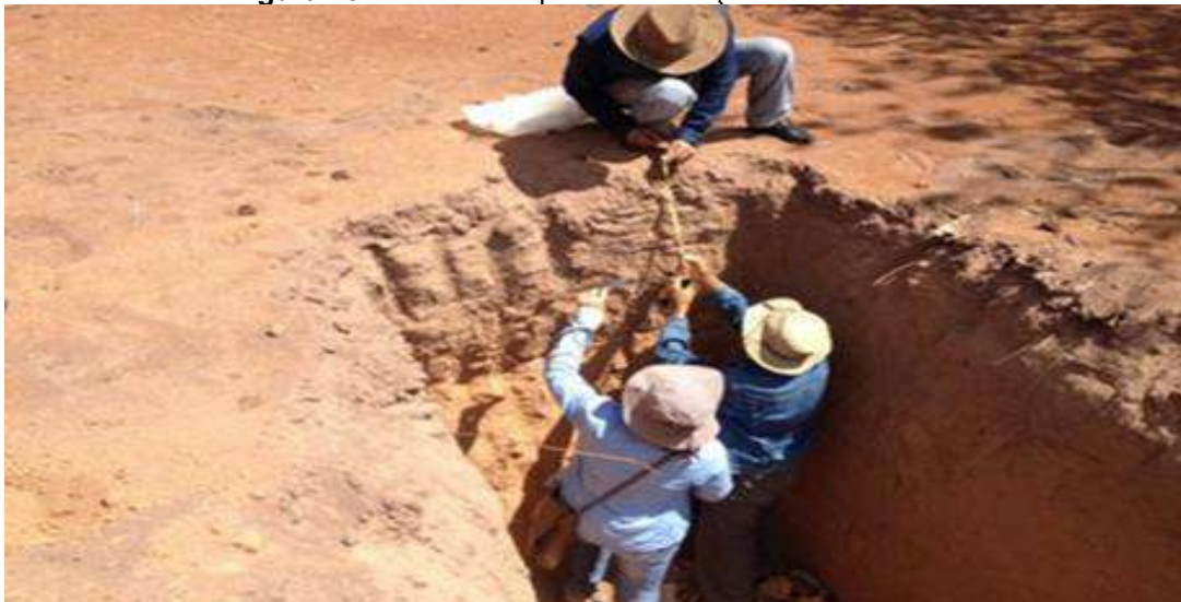
Figura 25: Abertura do perfil e descrição dos horizontes
